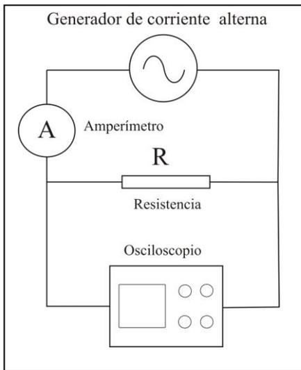
18. En el esquema de la figura, se dispone de un generador de CA, que suministra, un voltaje entre picos, en el osciloscopio de  $5,8V$ , si está conectado con una resistencia de  $500\Omega$ , se podrá decir que el amperímetro A marcará:
