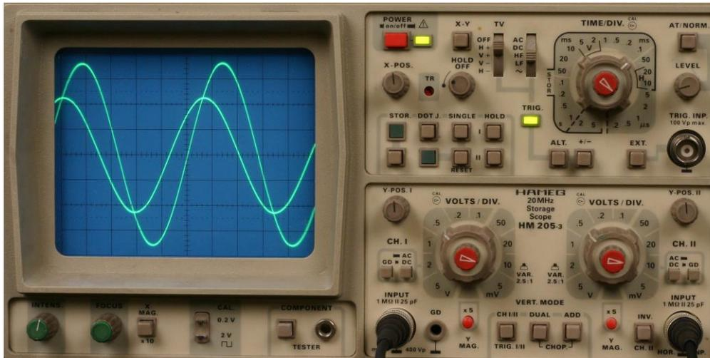
16. En el osciloscopio dado se aprecian 2 corrientes alternas cuyas fases no coinciden, la 1(picos bajos), y la 2(picos altos). De la observación de sus constantes y características se podrá deducir que sus ecuaciones respectivas serán:
